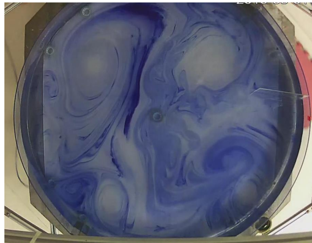
图5 平底水槽 Rossby 准静止波实验
